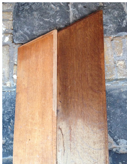
48. Kleurverschil vóór en na de behandeling met ammonia en nieuwe was. Ook de spiegels kleuren donker.
