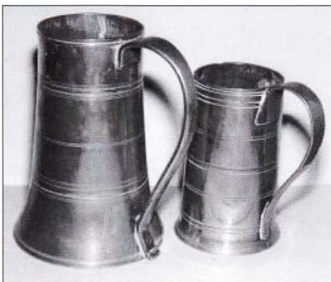
Afb. 10a Twee messing inhoudsmaten, gegoten, met ingezette latoenkoperen bodem. Het grote exemplaar is links van het handvat gemerkt met een jaarletter Y en hoorn; inhoud bepaald door waterweging op 714,5 ml (1 pint voor wijn en gedestilleerd). Het kleine exemplaar is ongemerkt en meet 352,5 ml.
