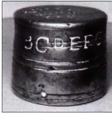
Afb. 7a-c Blokgewicht van 1 pond, geijkt in Hoorn, 1729, 1737, 1741, 1781-1819.
