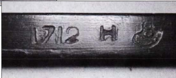
Afb. 11a/b Enkele ijkmerken op een ebbehouten ellestok, geijkt tussen 1660 en 1712: jaarletter X (1679) met hoorn bij het begin van de schaalverdeling, jaartal 1712 + bijbehorende jaarletter H.
